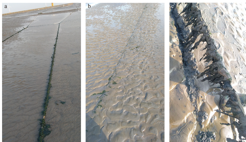
图3 梗绳原地落滩自然掩埋试验
