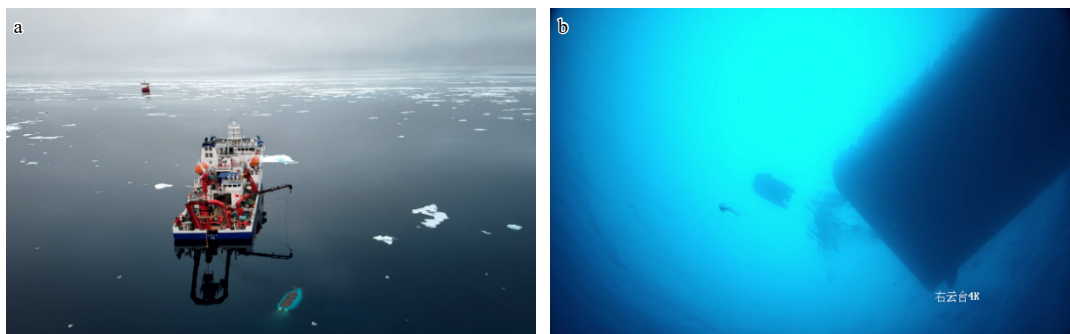
图4 “蛟龙”号基于多级可视化安全引导上浮(a)和水下“蛟龙”号摄像机画面(b)
